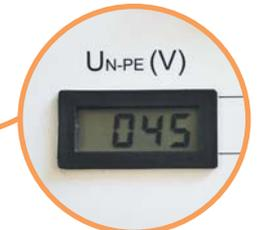
→ Отключение при напряжении  $45 \pm 5$  V на нейтральном проводнике
