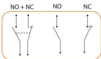
**Описание:** Блок контактов PS ETIMAT 10 применяется с серией автоматических выключателей ETIMAT 6, ETIMAT 10, ETIMAT 10 DC и монтируется с левой стороны. Во время монтажа блока контактов ручка автоматического выключателя должна быть в положении (OFF). Блок контактов служит для дистанционной сигнализации состояния контактной группы автоматического выключателя (включен/выключен).
