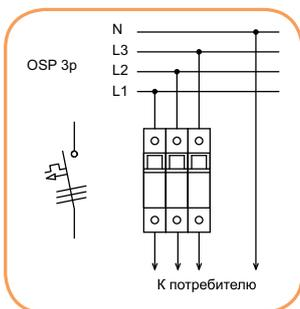
**Применение** - Ограничитель тока OSP-6 и OSP-10 выполняет функции автоматического выключателя, но с более точной настройкой тепловой защиты и применяется для ограничения отбора установленной максимальной мощности в электротехнических устройствах в быту и производстве. Особенностью изделия является возможность пломбирования и использования для ограничения потребления электрической энергии. Изделие предназначено для использования в любых отраслях.
