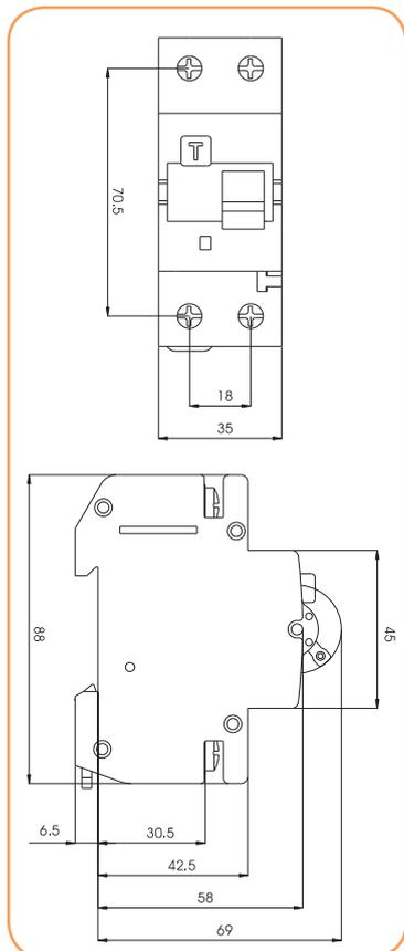
**Описание:** Выключатель является комбинацией дифференциального реле и автоматического выключателя.
