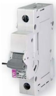
**Описание:** Независимый расцепитель DA ETIMAT P10 применяется для дистанционного отключения автоматических выключателей серии ETIMAT P10, ETIMAT P10 DC с номиналами от 0,5 до 63А и монтируется с правой стороны.
