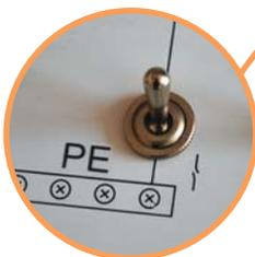
→ Отключение при обрыве заземляющего проводника
