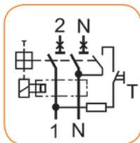
Дифференциальные автоматические выключатели LIMAT-SD имеют такие же функции, как KZS, но с отдельными блоками - автоматического выключателя и УЗО. Срабатывание каждого блока входящего в конструкцию происходит независимо. При срабатывании от перегрузки и токов короткого замыкания происходит отключение только блока автоматического выключателя. При срабатывании изделия вследствие возникновения токов утечки происходит отключение всего устройства (обоих блоков).
