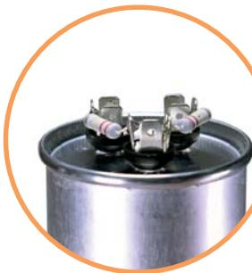
→ Для снятия остаточного напряжения все конденсаторные батареи оснащены разрядными резисторами (время разряда ≤ 3 минуты до 75 V)
