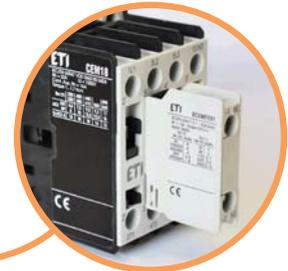
→ Фронтальный блок-контакт устанавливается непосредственно на часть подвижного сердечника, обеспечивая точную сигнализацию состояния силовых контактов
