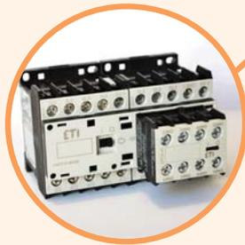
→ Для предотвращения подачи питания от двух источников одновременно, применяется взаимоблокировка, которая монтируется на фронтальной части устройств. На механическую блокировку могут быть установлены дополнительные блок-контакты
