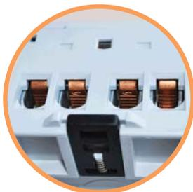
→ Зажимные клеммы контактора имеют специально нанесенные насечки для более надежного соединения, а специальный выступ предотвращает попадание проводника в корпус
