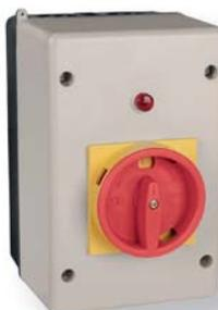
**Применение** - Щиты наружной установки с поворотной рукояткой предназначены для установки автоматических выключателей защиты двигателей МРЕ 25 и оснащены клеммами РЕ и N. Имеется возможность блокировки в выключенном состоянии одновременно тремя замками. Имеется возможность ввода проводников через герметичные сальники как снизу, так и сверху.
