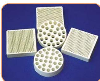
Керамические сите используются для удаления крупнодисперсных примесей из расплавленных материалов при температуре до 1700 °C. Их формы и размеры изготавливаются по индивидуальным заказам клиентов. Изделия соответствуют DIN 40680.
