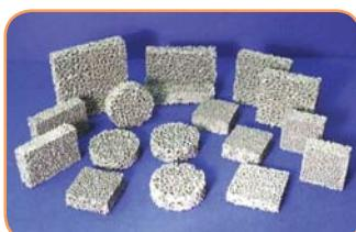
Пористые фильтры производятся на основе  $\text{SiC}$ . Они используются в промышленности для удаления неметаллических примесей, которые чаще всего становятся причиной поломок при литье. Характерная пористая структура определяет высокую площадь соприкосновения, что обеспечивает высокую степень фильтрации. Расплавленный металл, проходя через фильтр, плотно соприкасается с его пористой поверхностью, оставляя при этом на его стенках даже самые мелкие частицы ненужных примесей.
