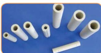
Корпуса цилиндрических предохранителей изготавливаются с помощью экструзии материала C410 или других силикатных смесей.
