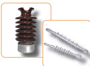
Керамические изоляторы для низкого и среднего напряжения изготавливаются из материала C110 и C120, соответствующего стандарту IEC 672. Они покрываются коричневой или белой глазурью. Коричневая глазурь соответствует RAL 8011, 8016, 8017. Технология производства и параметры изделий соответствуют DIN 40680.
