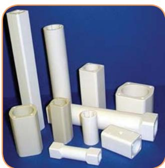
Для изготовления компонентов низковольтных предохранителей используется материал C610 (60 %  $\text{Al}_2\text{O}_3$ ) и безщелочной стеатит C221. Корпуса для предохранителей серии NH производятся по индивидуальным заказам (размеры, форма, технологические особенности) с помощью экструзии. Поверхность корпуса может быть покрыта специальной глазурью.
