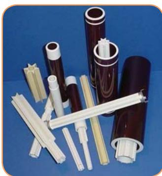
Корпуса высоковольтных предохранителей, производятся из высококачественного фарфорового глинозема C120 с помощью экструзии. Поверхность корпусов покрывается коричневой или белой глазурью (RAL 8011, 8016 или 8017). Отклонение размеров изделий не превышает норм по стандарту DIN 40680.
